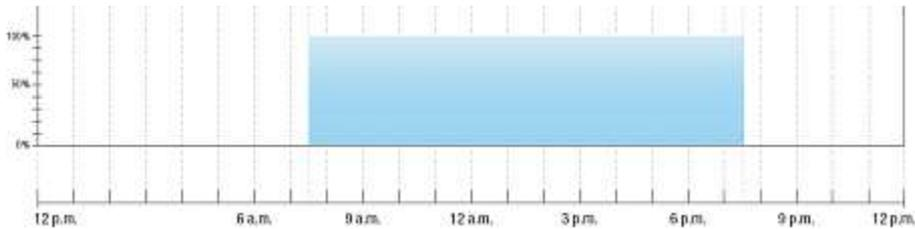
Typische Situation in einem Bürobau: Er ist mit modernen, energieeffizienten T5-Leuchten mit einem elektronischen Vorschaltgerät (EVG) ausgestattet. Mit Beginn der Arbeitszeit wird das Licht ein-, am Ende des Tages wieder ausgeschaltet.
